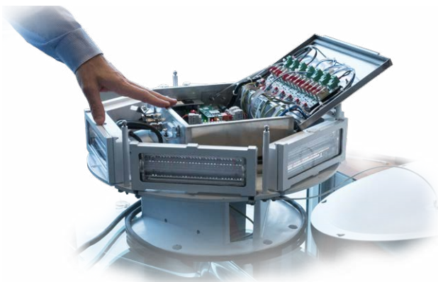
Balise avec alimentation 48 VCC intégrée Brevet : EP 1966535B1 & US 7816843
