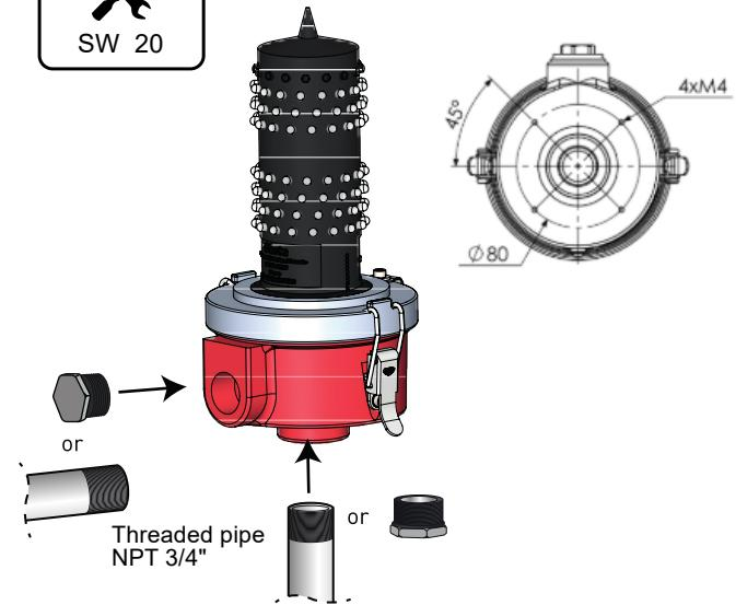
**Le luminaire doit être monté « à la verticale » (comme illustré) afin de respecter les spécifications optiques requises pour les feux d'obstacles à la navigation aérienne. S'il est monté dans une autre position, le luminaire ne sera pas considéré comme un feu d'obstacle à la navigation aérienne.**
