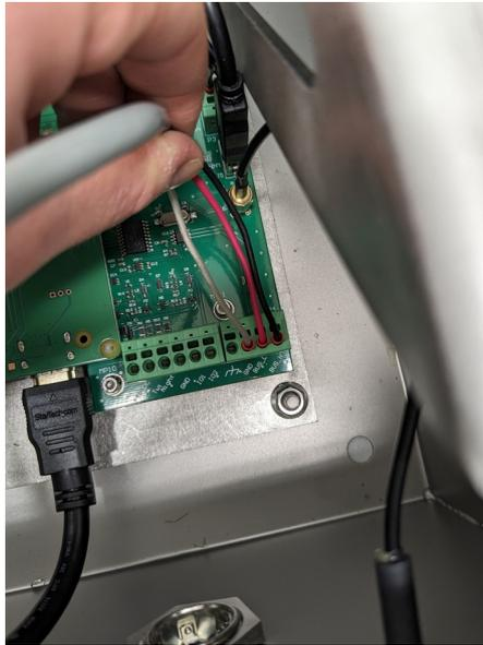
*Figure 33: Mise en place des fils du contrôleur CAN*
