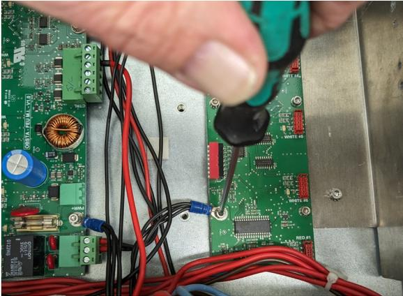
Figure 16: Retrait des vis de la carte de commande de droite
