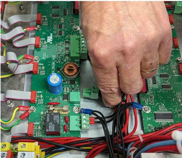
Figure 11: Déconnexion bornier alimentation carte de gauche
