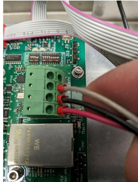
*Figure 34: Mise en place des fils sur le module CAN de la 113744B*
