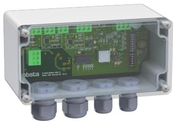
**Ce boîtier de commande est défini pour faciliter le suivi des installations de lampes de balisage NAVILITE 48V. Il permet le raccordement de 1 à 4 lampes fonctionnant simultanément (ou bien 2 lampes fonctionnant en redondance : 1 en fonctionnement "normal" et la seconde en "secours"), en permanence ou de nuit uniquement et avec détection d'alarme.**
